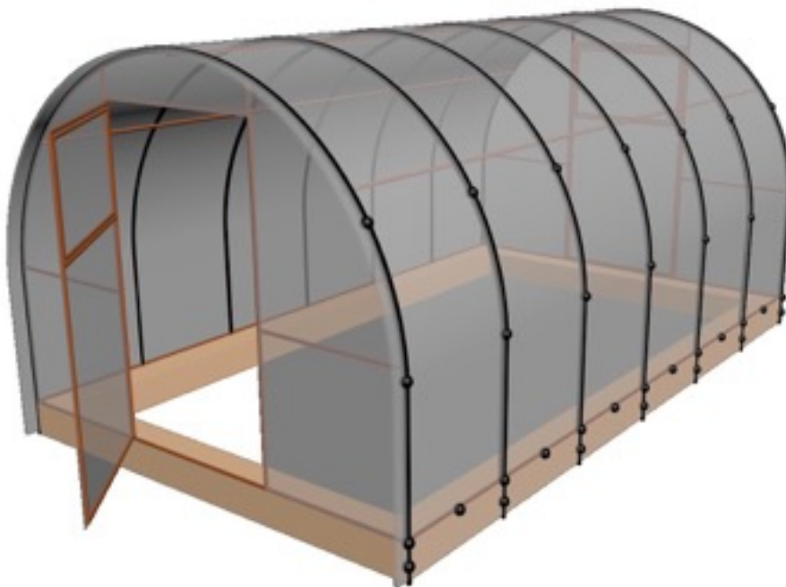
Рис. 10. Места крепления поликарбоната стяжными лентами
