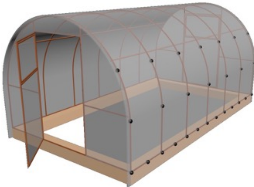
Рис. 9. Места крепления поликарбоната саморезами
