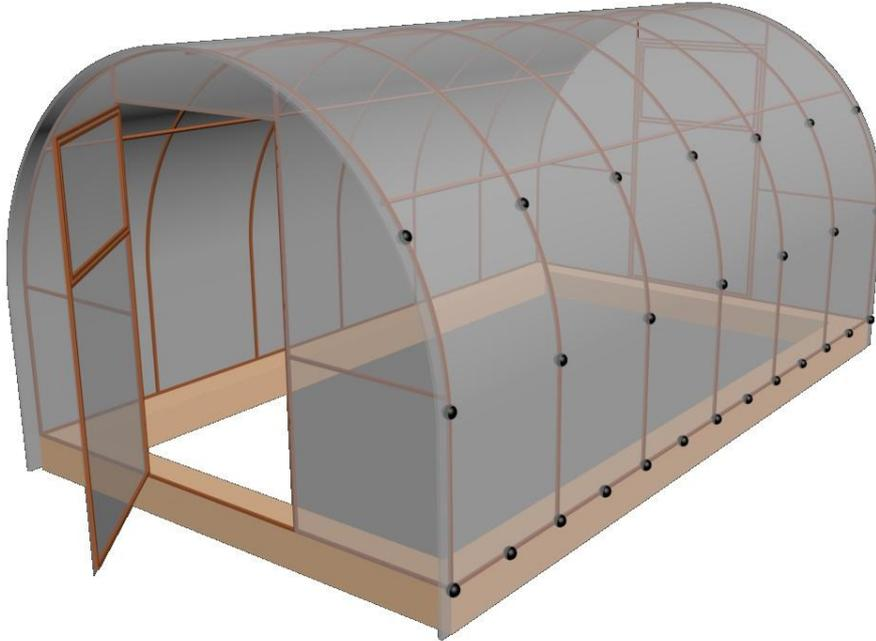
**Рис. 8. Места крепления поликарбоната саморезами**
