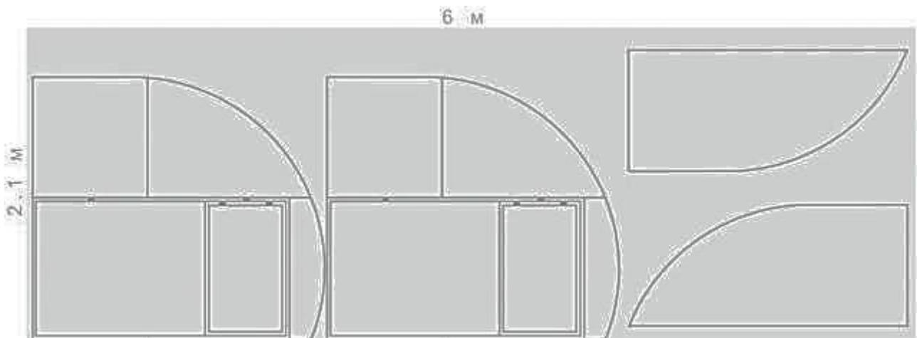
**Рис.4 Схема раскроя сотового поликарбоната**
