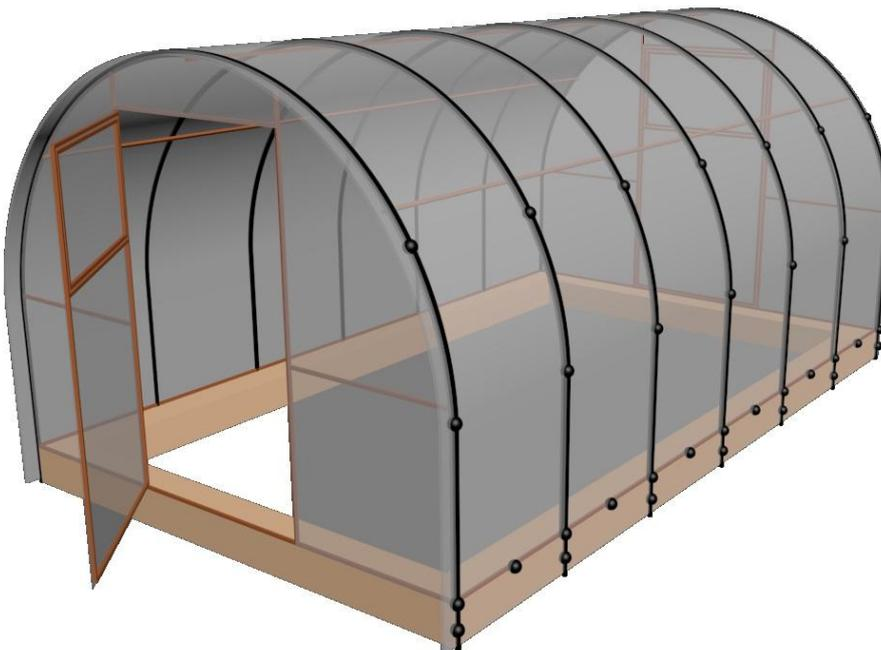
**Рис. 9. Места крепления поликарбоната стяжными лентами**
